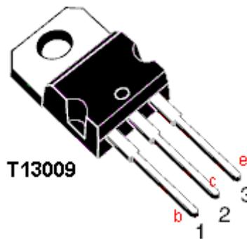
Dies ist ein Transistor, der schnell schaltet und die in der Lage ist 400 Volt und 12 Ampere Dauerstrom oder 24 Ampere in kurzen Impulsen zu behandeln. Der Basisstrom kann bis zu einem massiven 6 Ampere, Verlustleistung von 100 Watt und eine Stromverstärkung wahrscheinlich zwischen 20 und 40 in dieser Schaltung.
