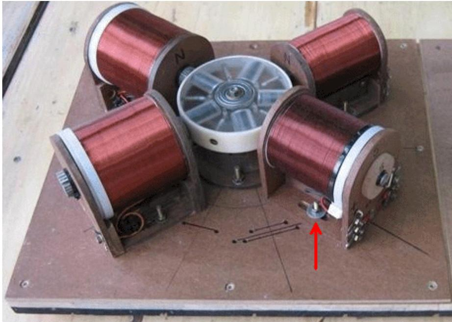
Bekanntmachung der Weg, den die Spule Montierungen können den Abstand zwischen den Windungen und der Rotor geändert werden. Die Arbeitsgruppe Lücke zwischen Rotor und Spulen kann angepasst werden, so dass die Leistung maximiert werden kann, indem die effektivste Lücke finden.
