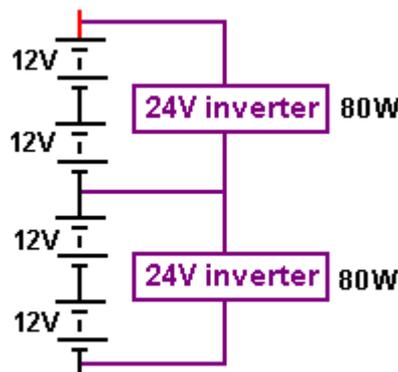
dann wegen der Doppel-Eingangsspannung , für die gleiche Stromaufnahme 80 Watt Netz sollte von jedem Wechselrichter zur Verfügung stehen. Vierundzwanzig-Volt-Wechselrichter sind recht häufig, da sie durch LKW-Fahrer und LKW verwendet werden, haben in der Regel 24-Volt-Systeme.
