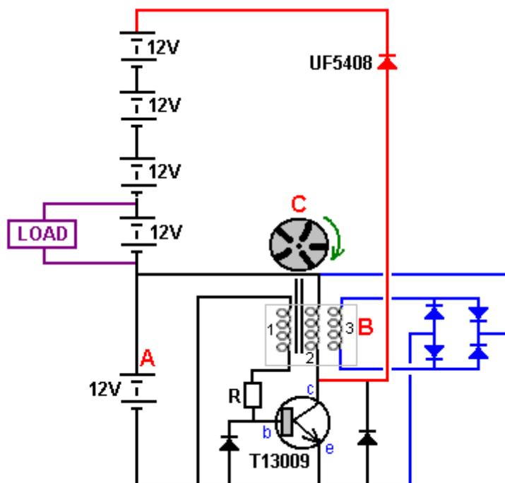
Die Batterie mit "A" versorgt die Schaltung. Ein Rotor "C", fünf Magneten enthält, wird so bewegt, dass einer der Magneten in der Nähe der Spulen durchläuft. Die Spulen gesetzt "B" hat drei speziell Spulen und der Magnet
