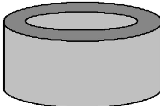
Este núcleo se enrolla con un cable grueso, tal vez AWG # 10 o 12 SWG (cable cuadrado de 2.3 x 2.3 mm). Las vueltas del cable deben estar apretadas, una al lado de la otra, y estar exactamente planas en la superficie superior, ya que el cepillo se deslizará hacia el cable:
