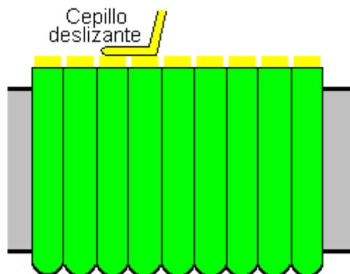
El contacto de latón deslizante o "cepillo" está dimensionado de manera que se conecta a través de dos cables adyacentes para que nunca haya chispas cuando el contacto del cepillo se desliza
