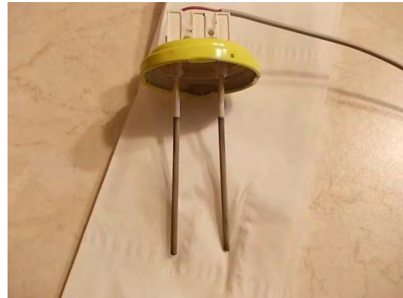
Électrodes après utilisation – les deux la même couleur
